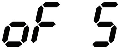
特殊菜單 2 - 當偏移出現偏差（偏移調整）時，將顯示歸零在偏移出現偏差將顯示「歸零」時，用按鈕 >>▲<< 和 >>▼<< 設定數字「0247」。透過同時按住這兩個按鈕加以確認。顯示幕上顯示「of S」。如果偏移量與環境壓力存在偏差，則現在需要透過壓力參考對設備施加壓力。為此，壓力必須與測量範圍起始值相符。若想將傳送器輸出的最新信號存作偏移量，請再次同時按下這兩個按鈕。不論幅度信號中的感測器信號是否移動，在顯示器上都顯示設定好的測量範圍起始值（Zero Point）。請注意，此次改動不涉及輸出端信號。此外，如果同時移動了偏移量，那麼也會移動幅度值（Full Scale）。
