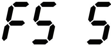
特殊菜單 1 - 當幅度信號存在偏差時校正顯示（幅度調整）在幅度出現偏差校正顯示時，用按鈕 >>▲<< 和 >>▼<< 設定數字 “0238”。透過同時按住這兩個按鈕加以確認。顯示幕上顯示「FS S」。現在需要透過壓力參考對設備施加壓力。為此，壓力必須與測量範圍終值相符。接著如果再次按下這兩個按鈕，那麼就會將傳送器輸出的最新信號存成幅度信號。從這個時間點開始，不論幅度信號中的感測器信號是否移動，在顯示器上都顯示設定好的測量範圍終值（End Point）。
