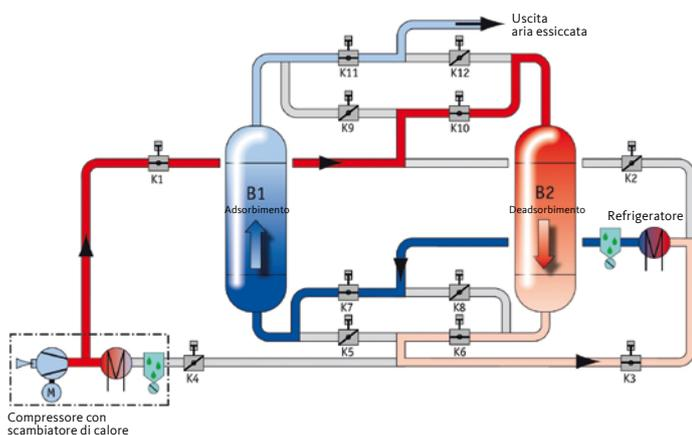
Il processo completo avviene alla pressione di esercizio nelle fasi di adsorbimento, deadsorbimento e raffreddamento. Questo metodo consente di sfruttare, nel processo di produzione di aria compressa oil-free, il calore generato dalla compressione per il deadsorbimento.
