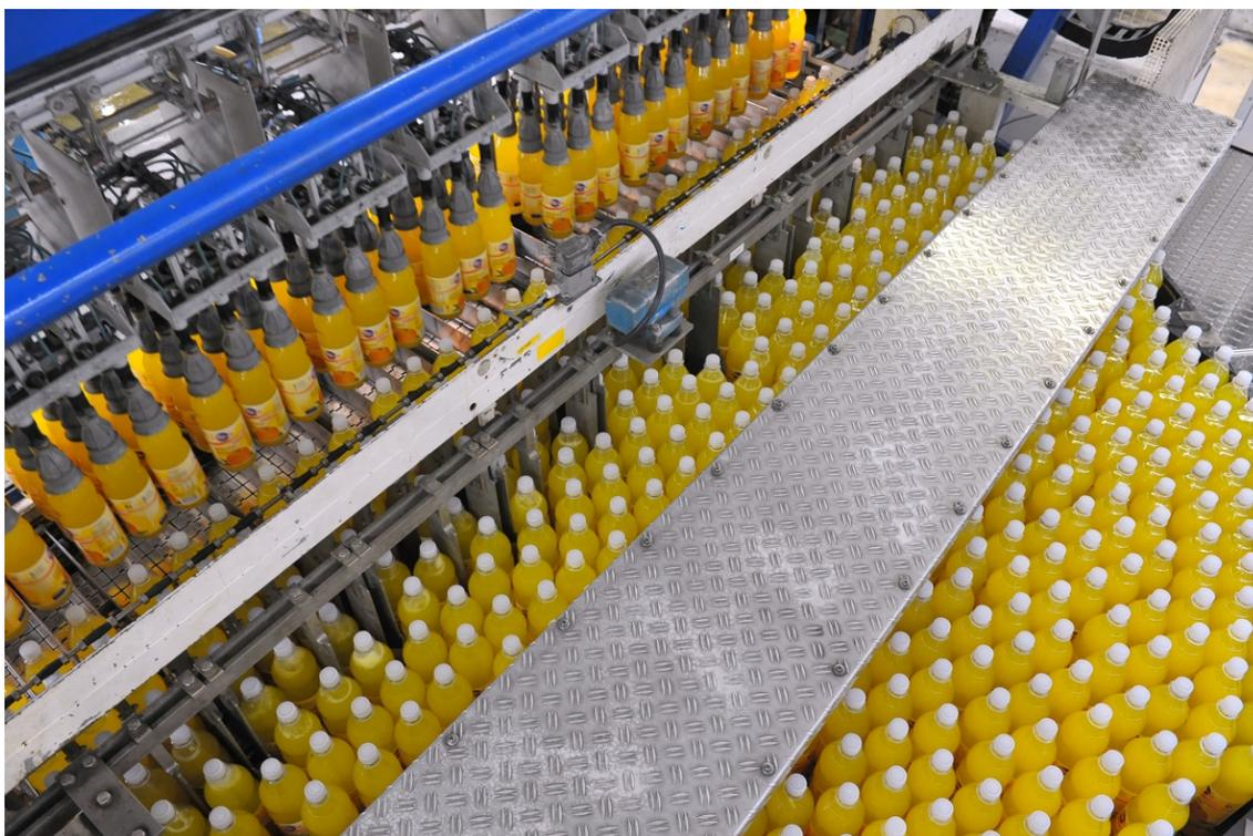
sino i requisiti del più elevato livello IFS versione 6. Visti questi requisiti di qualità, la tecnica di riempimento deve essere super sicura. Con un funzionamento di 24 ore al giorno per 6 giorni, l'azienda deve ricorrere costantemente a una tecnica di esercizio assolutamente sicura. L'aria compressa priva di olio è quindi un elemento cruciale.
