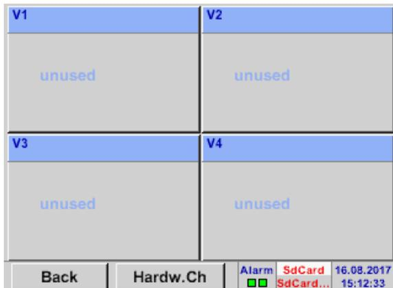
Après avoir appuyé sur le bouton **virtual channels** dans le menu Paramétrage Capteur, une vue d'ensemble des 4 canaux disponibles apparaît.
