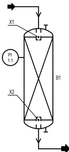
Pour réduire la perte de charge, le fond de la cuve est rempli d'une charge d'alumine active.
