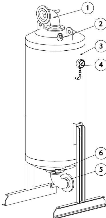
3. Laissez écouler le charbon actif usagé dans le conteneur collecteur. Veillez lors de cette opération à prévoir une aspiration suffisante de la poussière. Après vidange complète de la cuve, refermez ce raccord en remettant en place le joint et l'obturateur.
