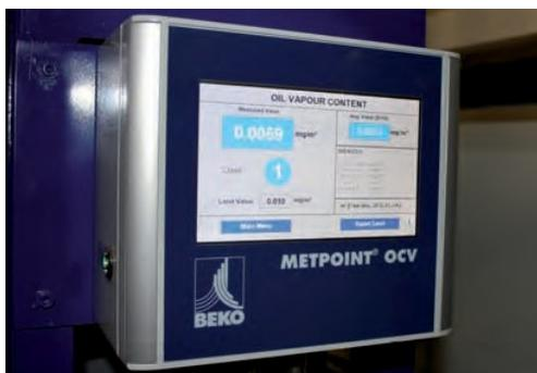
Grâce au dispositif de surveillance et de mesure de la teneur résiduelle en huile METPOINT OCV, la qualité de l'air comprimé de MAGNETTI MARELLI est visible et le client est certain de disposer d'un air comprimé de classe 1 selon ISO 8573-1.
