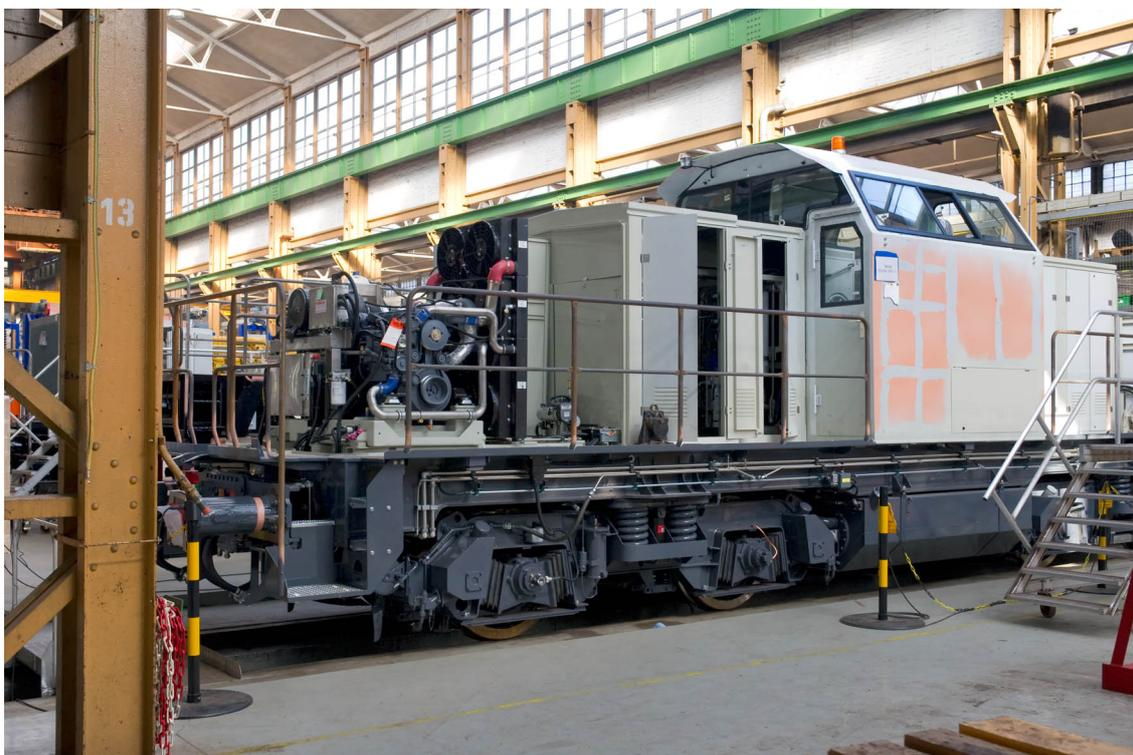
maniobras híbrida. Se construyó sobre el bastidor de la acreditada locomotora V100, con sus dos
