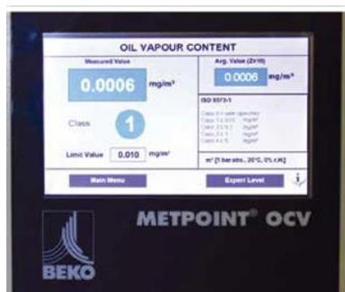
El sistema de supervisión METPOINT OCV controla la pureza del aire comprimido y certifica la alta calidad del aire comprimido de MONIN.
