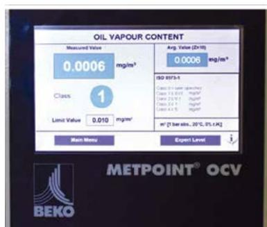
Das Monitoring-System METPOINT OCV überwacht die Reinheit der Druckluft und bescheinigt
